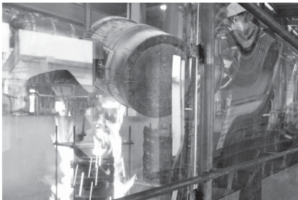
図 5-5 砂型に鉄を流し込む様子
