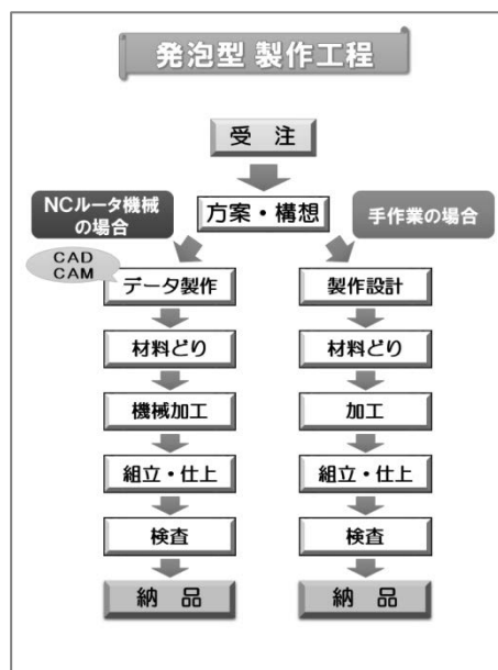
図 3-11 発泡型の製造工程
