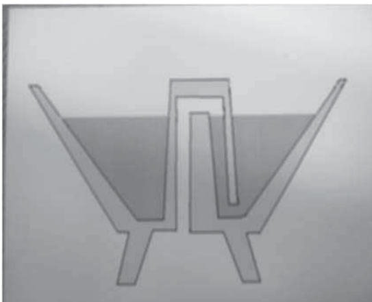
〈図4〉 十分杯の断面図1 八分目までの状態
