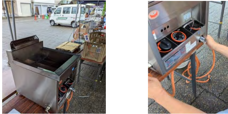
〔図表 26〕フライヤー、プロパンガスの設置と点火確認
