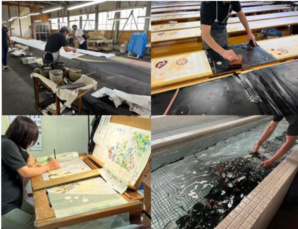
図 5-2 引き染め（左上）、糊置き（右上）、水洗い（右下）、手描き友禅（左下）の様子
